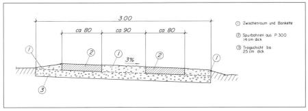
Abb. 4: Normalprofil eines Betonspurweges.
