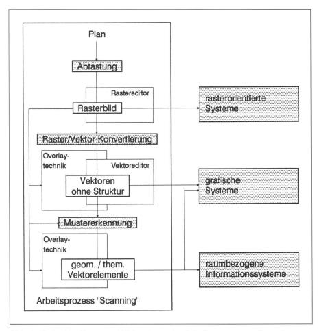
Abb. 2: Methoden, Daten und Zielsysteme des Arbeitsprozesses «Scanning».
