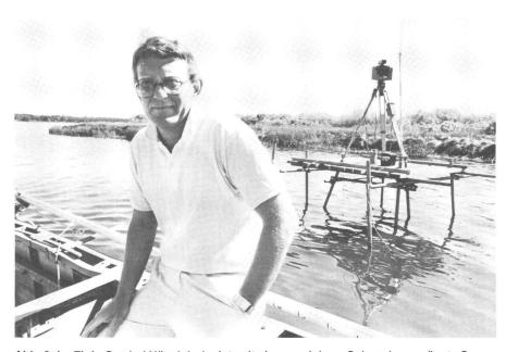
Abb. 2: Im Finja-See bei Hässleholm ist seit ein paar Jahren Schwedens grösste Seerestaurierung im Gange, die auch eine genaue Kartierung des Seebodens umfasst. Um kontinuierlich die genaue Position des Vermessungsschiffes bestimmen zu können, verwendet man seit Frühjahr ein Geodimeter 140T, das auf einer Plattform mitten im See aufgestellt ist.
