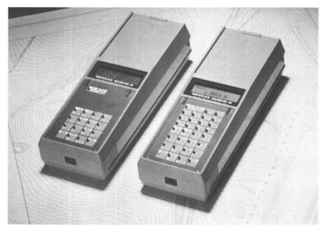
Die beiden Datenterminals Wild GRE4n und GRE4a sind serienmässig mit einem 32 K-BASIC-Programmodul und einer Einschubbatterie ausgestattet. Über die Tastaturen der beiden Geräte (GRE4n = numerisch, GRE4a = alpha-numerisch) lassen sich nach dem gleichen Konzept wie bei den elektronischen Wild-Vermessungsinstrumenten Bedienung und Datenfluss steuern. Beide Geräte sind durch den Benutzer frei programmierbar sowie extrem wetterfest und transportsicher.
