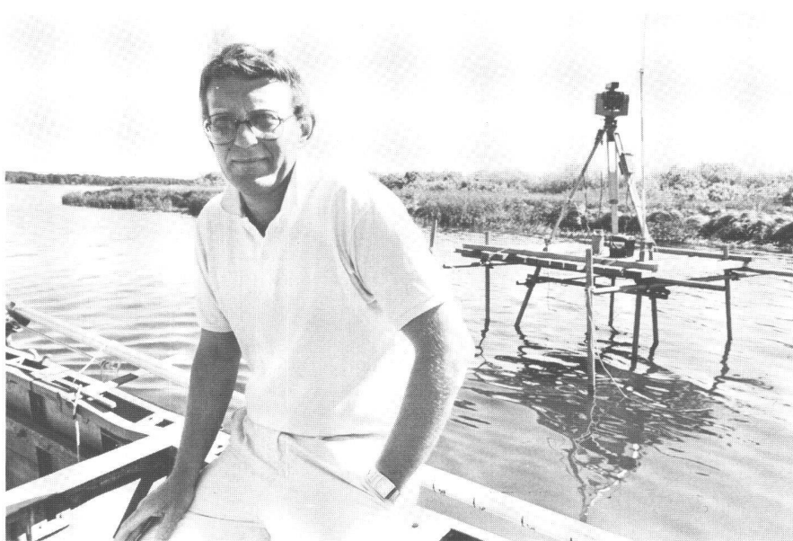
Abb. 2: Im Finja-See bei Hässleholm ist seit ein paar Jahren Schwedens grösste Seerestauration im Gange, die auch eine genaue Kartierung des Seebodens umfasst. Um kontinuierlich die genaue Position des Vermessungsschiffes bestimmen zu können, verwendet man seit Frühjahr ein Geodimeter 140T, das auf einer Plattform mitten im See aufgestellt ist.
