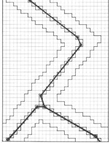
Abb. 16: Fehler bei der Vektorisierung / Erreurs systématiques d'une vectorisation
