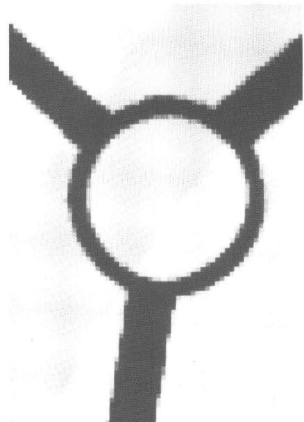
Abb. 4: Grauwertabtastung, 4 Graustufen / Quantification avec 4 valeurs de gris
