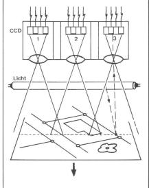
Abb. 11: Prinzip eines Durchlaufscanners / Schéma d'un balayage par ligne
