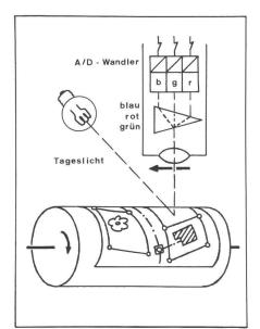
Abb. 8: Prinzip eines Trommelscanners, Auflicht / Schéma d'un scanner à tambour, réflexion de lumière
