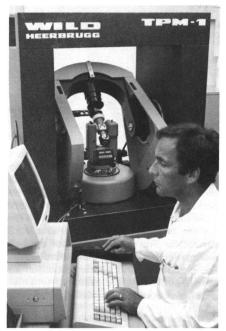
Wer die genauesten Theodolite des Weltmarktes baut, muss noch genauere Prüfmethoden schaffen: Keine einfache Sache, wenn man sich schon mit den Standard-Instrumenten an den Grenzen des technisch Machbaren bewegt. Mit dieser ersten vollautomatischen Theodolitprüfmaschine Wild TPM1, die aussieht wie ein gigantischer Theodolit, ist Wild Heerbrugg auch hier der Zeit voraus. Hier wird gerade bei einem Wild T1000 die Winkelmessgenauigkeit in allen Fernrohrstellungen kontrolliert.
