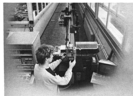
Auf dieser Messstrecke werden bei Wild Heerbrugg die Infrarot-Distanzmessgeräte Distanomat geprüft: Genauigkeiten von 1 mm auf 1 km Entfernung bringen die Spitzenmodelle dieser Instrumentenfamilie.
