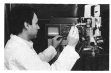
Durch Fertigung der elektronischen Theodolite nach produktionstechnisch modernsten Methoden konnten in den letzten Jahren bei Wild Heerbrugg die Herstellkosten gesenkt werden. Die mechanische und optische Präzision ist nach wie vor ein entscheidendes Kriterium. Doch zahlreiche Funktionen, die bei optischmechanischen Theodoliten teure Optik-, Feinmechanik- und Montagestunden kosteten, sind heute in diesen Instrumenten durch elektronische Bauteile gelöst.
