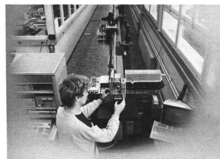
Auf dieser Messstrecke werden bei Wild Heerbrugg die Infrarot-Distanzmessgeräte Distanomat geprüft: Genauigkeiten von 1 mm auf 1 km Entfernung bringen die Spitzenmodelle dieser Instrumentenfamilie.
