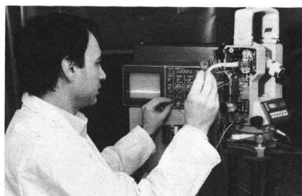
Durch Fertigung der elektronischen Theodolite nach produktionstechnisch modernsten Methoden konnten in den letzten Jahren bei Wild Heerbrugg die Herstellkosten gesenkt werden. Die mechanische und optische Präzision ist nach wie vor ein entscheidendes Kriterium. Doch zahlreiche Funktionen, die bei optisch-mechanischen Theodoliten teure Optik-, Feinmechanik- und Montagestunden kosten, sind heute in diesen Instrumenten durch elektronische Bauteile gelöst.
