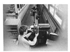
Auf dieser Messstrecke werden bei Wild Heerbrugg die Infrarot-Distanzmessgeräte Distomat geprüft: Genauigkeiten von 1 mm auf 1 km Entfernung bringen die Spitzenmodelle dieser Instrumentenfami-
