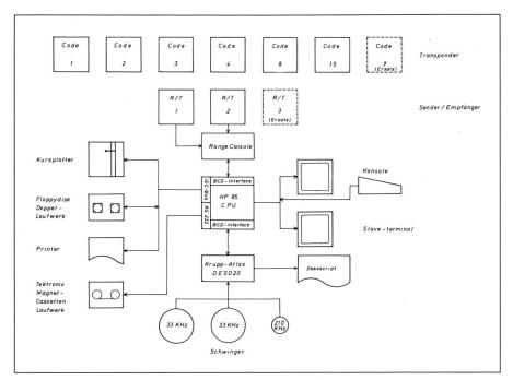
Abb. 2: Konfiguration der Messgeräte
