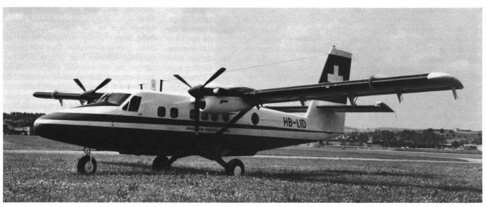
Abb. 1: Vermessungsflugzeug «Twin Otter», Typ DHC-6-300. Aufnahme erstellt durch das Bundesamt für Militärflugplätze.
