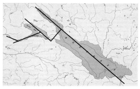
Abb. 4: Das Vermessungsschiff fährt auf Profilen, die senkrecht zu diesen vorgegebenen Achsen stehen.
