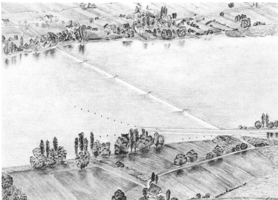
Abb. 5: Zusatzprojekt C von Bächtold 1973. Überflutbares Schlauchwehr bei Ohningen mit Schiffsschleuse. Projektskizze für den Niederwasserzustand.
