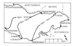
Abb. 4: Linienführung der ersten Telegraphenkabel im östlichen Bodensee. Rutschungen von Rheindelta-Sedimenten verursachten verschiedene Kabelbrüche. Erst in genügender Entfernung vom Delta konnte der Betrieb störungsfrei aufrechterhalten werden.
