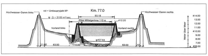
Abb. 4: Typisches Querprofil im Bereich der oberen Durchstichsbrücke (Diepoldsau). Eingezeichnet ist das neue Mittelgerinne nach dem Umbauprojekt IIIb.
