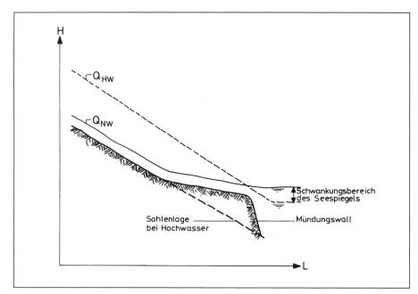
Abb. 3: Sohlenbildung bei einer Flussmündung und «Mündungswall».
