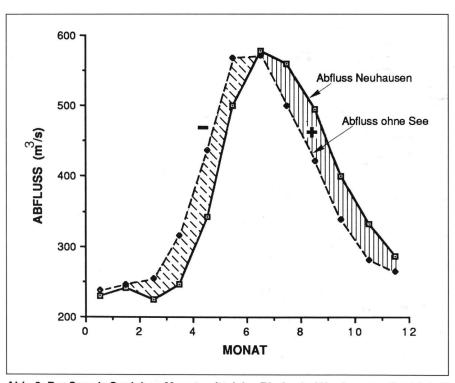
Abb. 2: Der See als Speicher: Monatsmittel des Rheins bei Neuhausen. Gestrichelt eingetragen ist der Abfluss an der gleichen Stelle, wie er sich ohne Retentionswirkung des Sees ergeben würde.
