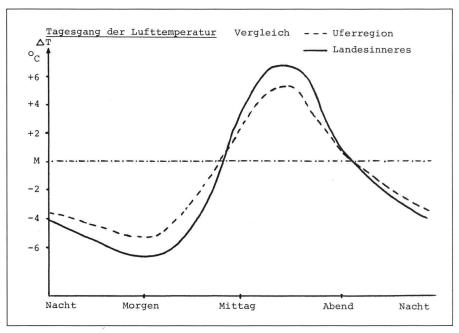
Tagesgang der Lufttemperatur im Vergleich zwischen Uferregion und Landesinnerem: im Laufe eines ungestörten, sonnigen Tages ist die Temperaturabweichung vom Tagesmittelwert (M) an einer Uferstation deutlich kleiner als an einem Ort im Landesinnern.  $\triangle T =$  Temperaturabweichung.
