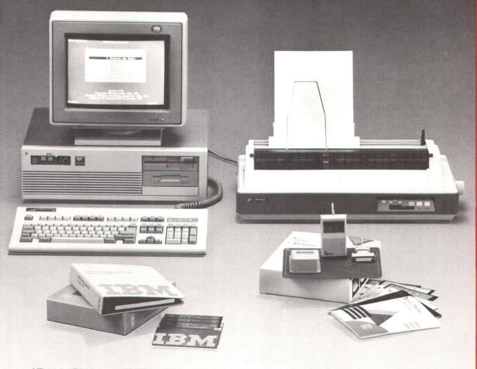
AT-286, IBM kompatibel, 8/10/12 MHz selektierbar, 640 KB RAM, 5,25" und 3,5" Floppy, 20 MB Harddisk, 14" Farbmonitor, VSM-Tastatur, MANDAX-EL 2415/24-Nadel Matrixdruk-ker mit Einzelblatteinzug auch für A4 quer, Genius-Maus mit DrHalo III Paint-Software, IBM-Writing Assist2 Textverarbeitungs-Software, MS-DOS 3.3 mit Disketten und Handbuch.
