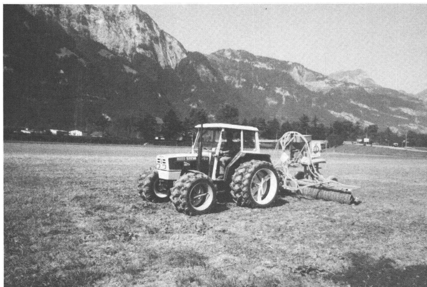
Abb. 2: Einsatz der hydraulischen Sämaschine: Der Traktor mit Doppelbereifung sichert eine bodenschonende Bearbeitung.
