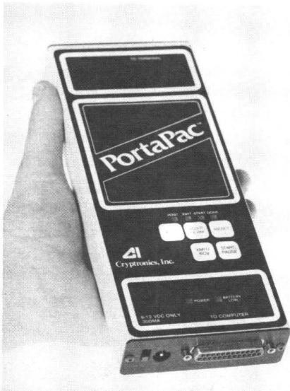
Das Portapac ist ein äusserst kompaktes und handliches in Halbleitertechnik aufgebautes Datenspeicher- und Transfergerät. Seine Masse betragen H 25 x B 90 x T 231 mm. Die Robustheit verdankt es einem extrudierten Aluminiumgehäuse. Der Ni-Cad-Akku erlaubt 6 Stunden netzunabhängigen Betrieb. Pro Akkuladung können die Daten bis zu 6 Monaten im Speicher gehalten werden. Ein Ladegerät 220 VAC wird mit dem Portapac mitgeliefert.
