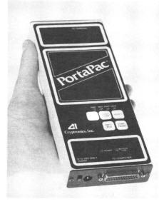
Das Portapac ist ein äusserst kompaktes und handliches in Halbleitertechnik aufgebautes Datenspeicher- und Transfergerät. Seine Masse betragen H 25 × B 90 × T 231 mm. Die Robustheit verdankt es einem extrudierten Aluminiumgehäuse. Der Ni-Cad-Akku erlaubt 6 Stunden netzunabhängigen Betrieb. Pro Akkuladung können die Daten bis zu 6 Monaten im Speicher gehalten werden. Ein Ladegerät 220 VAC wird mit dem Portapac mitgeliefert.
