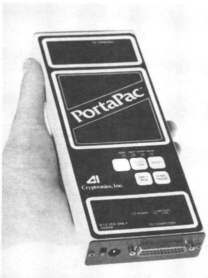
Das Portapac ist ein äusserst kompaktes und handliches in Halbleitertechnik aufgebautes Datenspeicher- und Transfergerät. Seine Masse betragen H 25 × B 90 × T 231 mm. Die Robustheit verdankt es einem extrudierten Aluminiumgehäuse. Der Ni-Cad-Akku erlaubt 6 Stunden netzunabhängigen Betrieb. Pro Akkuladung können die Daten bis zu 6 Monaten im Speicher gehalten werden. Ein Ladegerät 220 VAC wird mit dem Portapac mitgeliefert.
