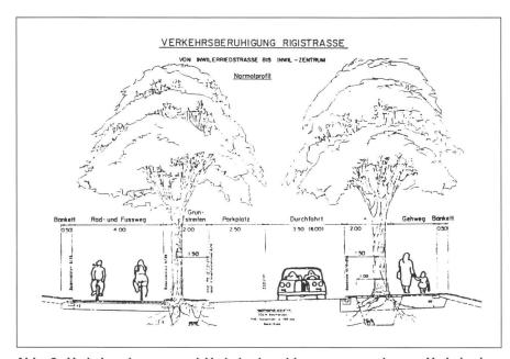
Abb. 2: Verkehrsplanung und Verkehrsberuhigungsmassnahmen: Verkehrslenkung, Verkehrssicherheit und Strassenraumgestaltung durch bauliche Massnahmen (Bild: Bauamt Baar).
