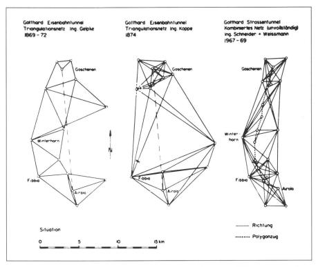
Abb. 1: Triangulationsnetze für die Absteckung der Bahn- und Strassentunnel am St. Gotthard. (Foto: W. Schneider AG).
