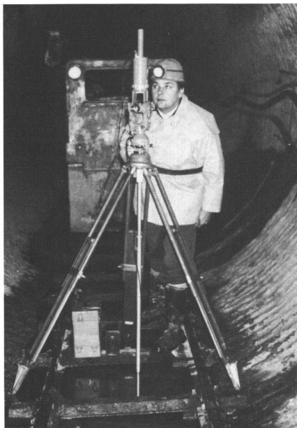
Abb. 2: Achs-Kontrolle mit dem Kreiseltheodolit in einem Abwasser-Stollen. (Foto: W. Schneider AG).
