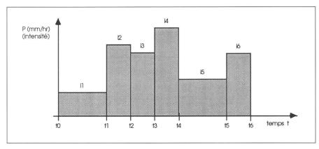
Fig. 5: Discrétisation de la pluie observée
