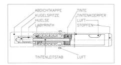
Abb. 6: Querschnitt durch einen Labyrinth-Kugelschreibstift. Der Druckausgleich findet über das Labyrinth statt.
