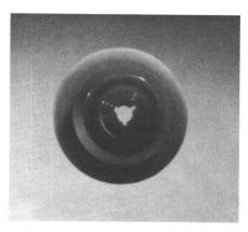
Abb. 2: Frontalansicht der Schreibspitzenöffnung des in Abb. 1 (Mitte) dargestellten HP-Tintenkörpers (2fach vergrössert). Die 3 Nuten dienen dem Belüften des Tintenspeichers.
