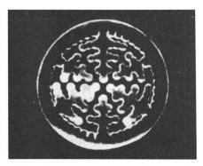
Abb. 4: Stark vergrösserter Querschnitt einer extrudierten Plastik-Schreibspitze. Die tannenbaumförmigen Rippen erhöhen die Kapillarwirkung.
