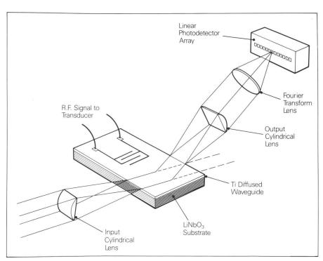
Fig. 12: Analyseur de spectre RF à cellule Bragg. L'interaction d'un faisceau lumineux guide avec le réseau mobile créé par une onde de surface acoustique sur le cristal de niobate de lithium, génère des faisceaux diffractés, séparés angulairement. L'intensité de chaque faisceau est une mesure de la force du composant RF correspondant dans le signal d'excitation.
