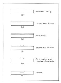
Fig. 3: Etapes de la fabrication d'un guide d'ondes à canal, par diffusion de titane dans du niobate de lithium.
