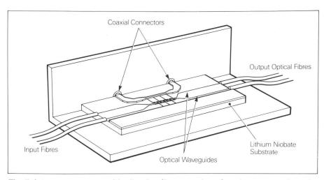
Fig. 7: Interrupteur pour guide d'ondes électro-optique à ondes progressives. La vitesse de fonctionnement du dispositif illustré à la fig. 4 est fondamentalement limitée par la capacité d'électrode. On peut obtenir une plus grande vitesse de fonctionnement, en utilisant la structure d'électrodes à ondes progressives illustrée ici. Le signal électrique injecté se propage sur le «stripline» parallèlement aux ondes optiques, établissant ainsi une interaction cumulative.
