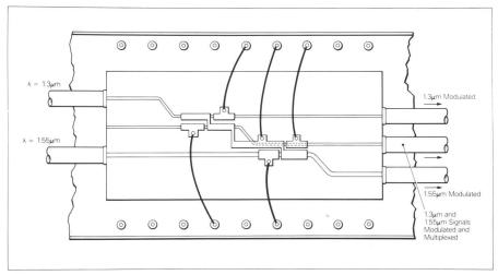
Fig. 11: Modulateur-multiplexeur. Par interconnexion de dispositifs guides d'ondes sur un substrat unique, on obtient des composants multifonctions. Ici, deux coupleurs directifs de caractéristiques différentes, sont interconnectés pour produire un composant offrant une modulation et un multiplexage indépendants de deux longueurs d'onde: 1,3 et 1,55  $\mu$ m.
