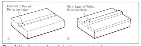
Fig. 1: Guides d'ondes optiques. La lumière est contrainte à se propager dans les zones dont l'indice de réfraction est supérieur à celui du milieu avoisinant. La structure à canal (a) est aisément obtenue par diffusion, par exemple de titane dans du niobate de lithium; les variations sur la structure à nervure (b) sont généralement utilisées pour les guides d'ondes à semi-conducteurs.
