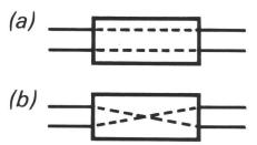
Fig. 5: Etats «traversée directe» et «croisement» de l'interrupteur pour guide d'ondes électro-optique.
