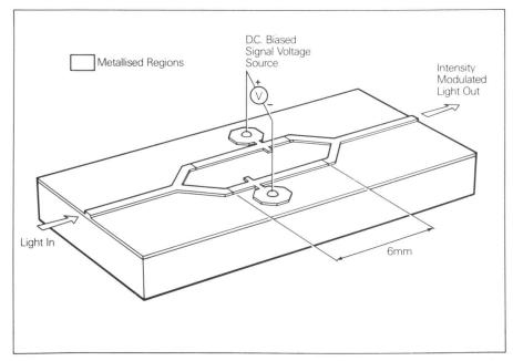
Fig. 8: Modulateur de guide d'ondes interférométrique. Dans la structure Mach-Zehnder, la lumière est divisée, puis recombinée dans des guides d'ondes joints en Y. La tension électrique appliquée entre les bras produit un retard de phase différentiel avec une interférence constructrice, et destructrice sur le guide d'ondes de sortie.
