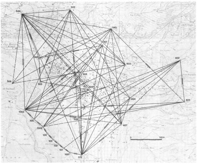
Fig.: Canevas simplifié des mesures effectuées.
