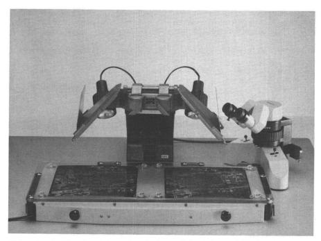
Abb. 6: Wild ST4 Spiegelstereoskop (mit parallel geführtem Bildträger).
