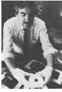
Wissenschafter im IBM Forschungszentrum Almaden in San José/Kalifornien haben eine experimentelle Magnetplatte entwickelt, auf der – bei einem Durchmesser von weniger als neun Zentimetern – 10 Milliarden Bits oder 620 000 Schreibmaschinenseiten gespeichert werden könnten. Die Aufzeichnungsdichte ist dabei fünfzig mal höher als bisher, und die Spuren sind 100 mal dünner als ein menschliches Haar.
