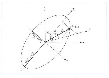
Abb. 3: Fehlerellipse
