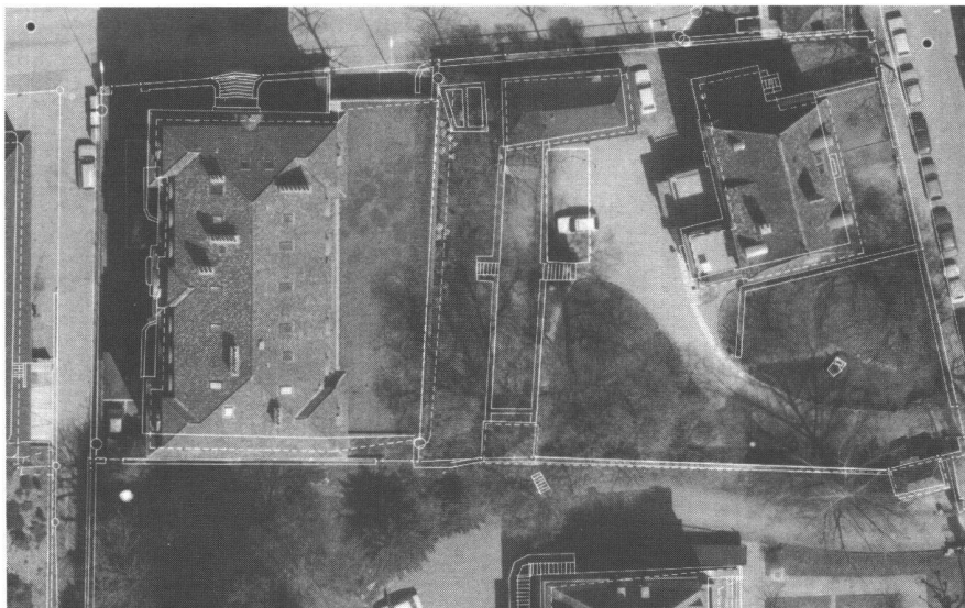
Abb. 5: Überlagerung einer Luftbildvergrösserung mit dem projektiv umgeformten Grundbuchplan. Für die Umformung wurden die Höhen und die Orientierungselemente der Luftbilder miteinbezogen. Die Gebäudeumrisse wurden zweimal gezeichnet, einmal auf Bodenebene und einmal in Höhe der Dachtraufe (gestrichelt). Man beachte verschiedene Baulichkeiten sowie Mauern und Treppen, die nicht mehr der Realität entsprechen.
