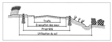
Fig. 1: Exemple de définitions à normer: Différentes notions de largeur de route.
