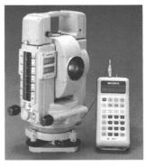
Die Totalstation Et-1 ist das Flaggschiff einer kompletten Gerätefamilie für die computerunterstützte und millimetergenaue Vermessung. Reichweiten von bis zu 2600 m, elektronische Winkelmessung, berührungsfreie Bedienung, automatische Kompensation der Erdkrümmung und externe Datenspeicher sind nur einige der vielen Rosinen.
