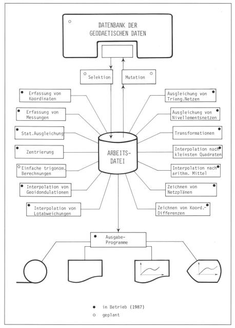
Abb. 7: Das geodätische Programmsystem der Landestopographie
