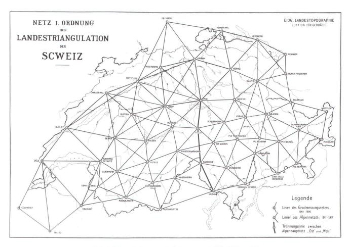
Abb. 1: Triangulationsnetz 1. Ordnung nach Zölly [40], p. 115
