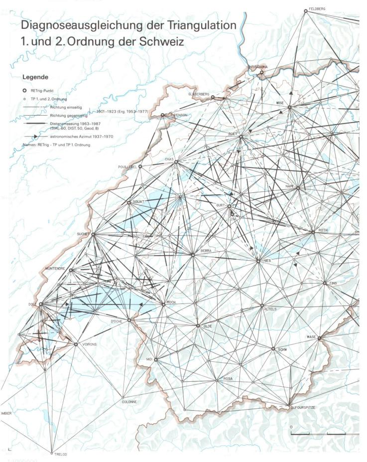
Abb. 3: Trigonometrisches Netz 1. und 1
