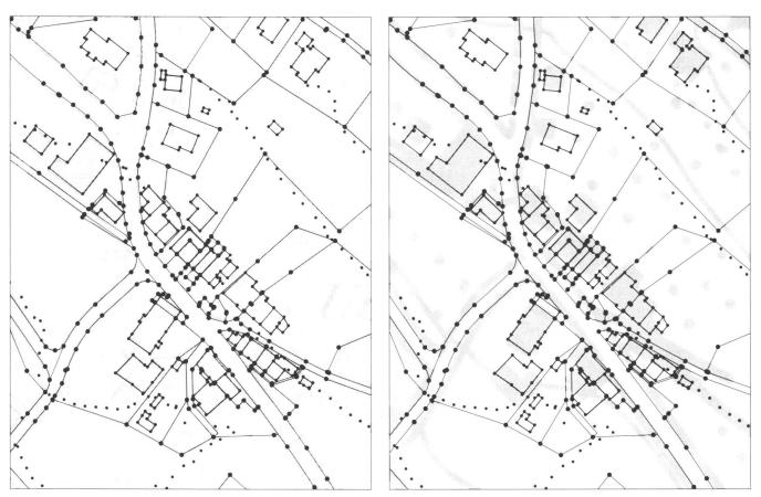
Abb. 7: Grenzpunkte, Hausecken und Stützpunkte der Höhenkurven aus dem Grunddatensatz 1:500 übertragen auf den Übersichtsplan 1:5000 und auf die Landeskarte 1:25000, beide auf den Massstab 1:2000 vergrössert und aufgerastert. Man erkennt, dass vor allem in der Landeskarte ganz andere Koordinaten erforderlich wären, als sie von der Katastervermessung geliefert werden.
