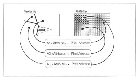
Abb. 6: Prinzip der hybriden Verarbeitung von Vektor- und Rasterdaten [nach E. Hutzler].
