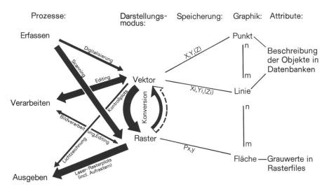
Abb. 5: Schema eines für die Kartographie geeigneten interaktiven Graphiksystems [nach E. Hutzler].
