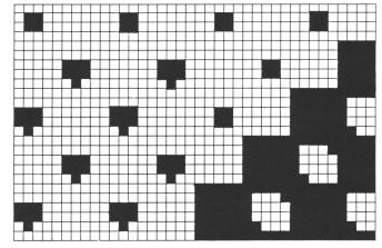
Abb. 4: Rastermuster des Cyan- und Schwarzauszuges mit 18°, resp. 45° Rasterwinkelung und einer Pixelgrösse von 25  $\mu$ m.
