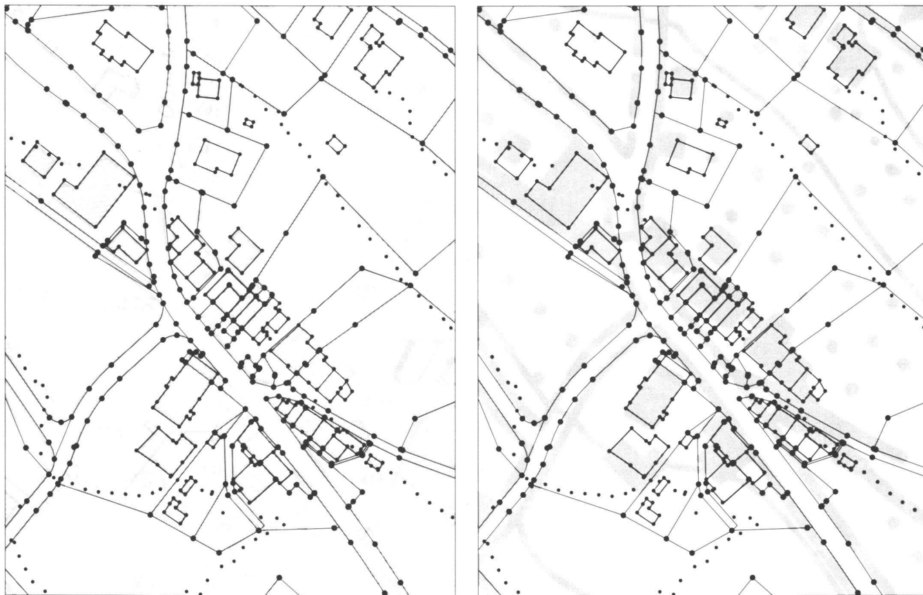
Abb. 7: Grenzpunkte, Hausecken und Stützpunkte der Höhenkurven aus dem Grunddatensatz 1:500 übertragen auf den Übersichtsplan 1:5000 und auf die Landeskarte 1:25000, beide auf den Massstab 1:2000 vergrössert und aufgerastert. Man erkennt, dass vor allem in der Landeskarte ganz andere Koordinaten erforderlich wären, als sie von der Katastervermessung geliefert werden.
