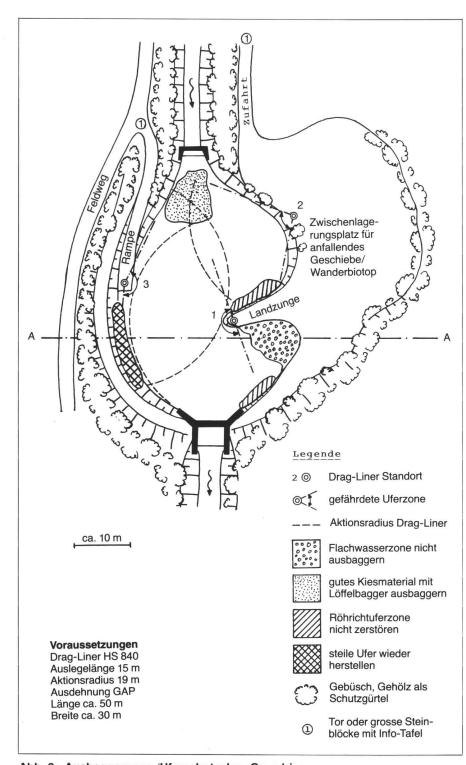
Abb. 3: Ausbaggerungs-/Uferschutzplan: Grundriss.
