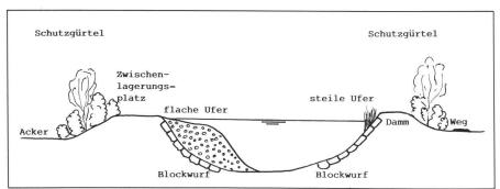
Abb. 4: Ausbaggerungs-/Uferschutzplan: Schnitt A-A.
