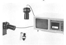
in der Dimensionskontrolle, bei der Teileidentifikation, bei der Positionsmessung oder der Oberflächenkontrolle von Werkstücken, in der Vollständigkeitskontrolle bei Montage oder Verpackung, im Sicherheitsbereich usw.
