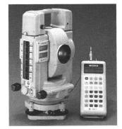
Die Totalstation Et-1 ist das Flaggschiff einer kompletten Gerätefamilie für die computerunterstützte und millimetergenaue Vermessung. Reichweiten von bis zu 2600 m, elektronische Winkelmessung, berührungsfreie Bedienung, automatische Kompensation der Erdkrümmung und externe Datenspeicher sind nur einige
