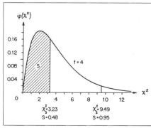
Abb. 7: Hauptnetz, Anpassungstest mittels Schleifenwidersprüchen
