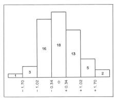
Abb. 6: Hauptnetz, Histogramm der Schleifenschlussfehler
