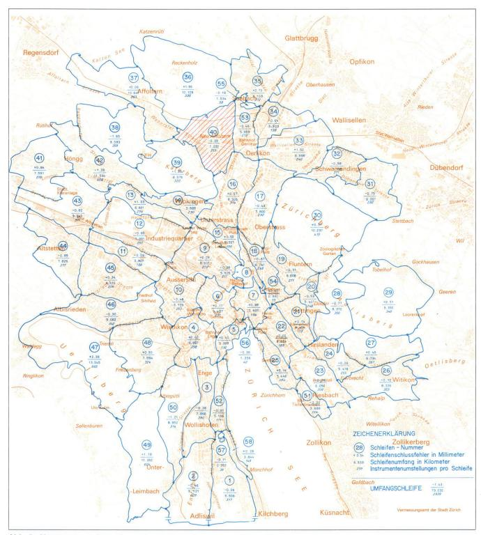
Abb. 3: Hauptnetz mit Schleifenschlussfehlern, Messungen 1979 – 1981
