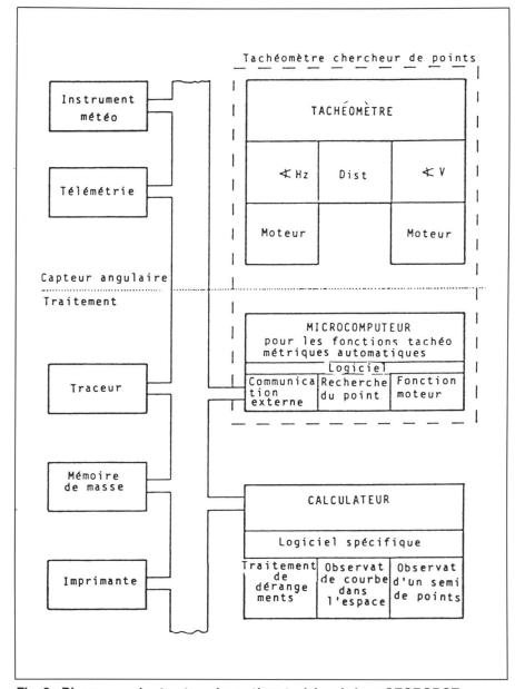
Fig. 2: Diagramme de structure du système tachéométrique GEOROBOT.
