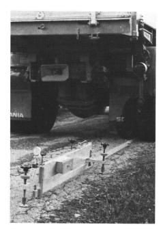
Abb. 5: Deflektionsmessung mit dem Benkelman-Balken. Dabei wird die elastische Einsenkung (elastische Deflektion) der Strassenoberfläche unter der ruhenden Belastung des Zwillingsrades eines Lastwagens gemessen (Foto: Ch. Boss).
