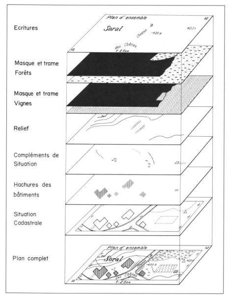
Fig. 1: Schéma de production du plan d'ensemble par couches séparées.
