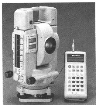
Die Totalstation Et-1 ist das Flaggschiff einer kompletten Gerätefamilie für die computerunterstützte und millimetergenaue Vermessung. Reichweiten von bis zu 2600 m, elektronische Winkelmessung, berührungslose Bedienung, automatische Kompensation der Erdkrümmung und externe Datenspeicher sind nur einige der vielen Positiven.
