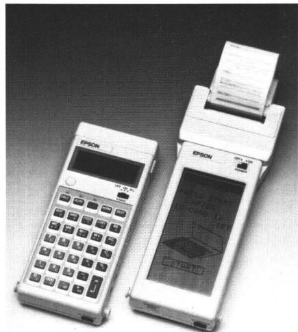
Zur Erfassung vor Ort bringt das EPSON Handy Terminal neue Lösungen. Der Bediener kennt durch die programmierbare Menüführung die gewünschten Eingaben, und das EHT prüft die Daten auf ihre Plausibilität hin. Sämtliche Daten liegen auf einer IC-Karte, die einfach in das Handy Terminal eingesteckt wird.
