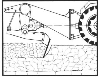
Abb. 2: Das Gerät in schematischer Seitenansicht, links im Einsatz zur Tieflockerung mit Tiefdüngung, rechts zur Oberbodenbearbeitung. Der an einem Rahmen (1) mit einem verstellbaren Hebel (2) angehängte Arbeitsarm (3) versetzt die Arbeitswerkzeuge oder Schare (4) mit Hilfe eines Exzenters (5) in ellipsenförmige Bewegungen. Links ist noch die Düngeranlage (7) aufgesetzt.
