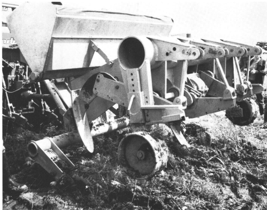
Abb. 3: Das Tieflockerungsgerät mit hochgezogenen Scharen. Links oben erkennt man den Behälter für die Düngstoffe.
