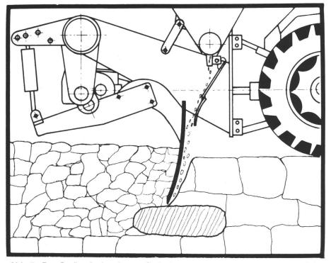
Abb. 5: Das Gerät mit eingebauter Steinsicherung (Hydraulik-Zylinder oben links im Bild).
