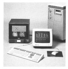
Dabei wird zwischen VAX oder micro-VAX2 und Workstation IS 100 eine serielle und parallele Kopplung durchgeführt.
