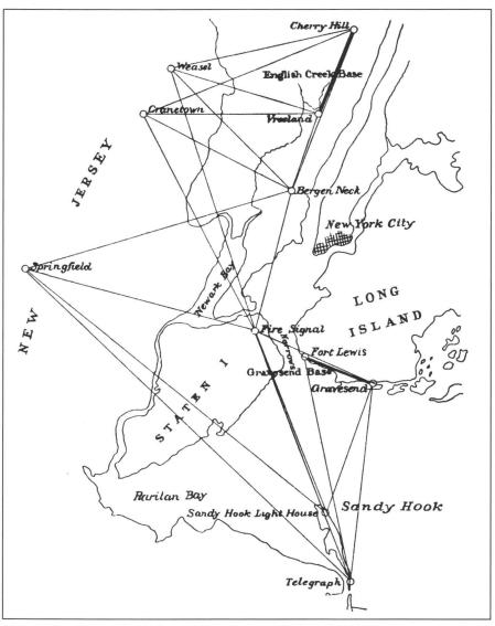
Abb. 2: Hasslers erstes Triangulationsnetz in USA 1816/1817.
