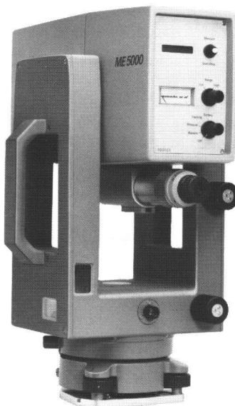
Das Helium-Laserlicht als Strahlungsquelle und ein einziger Kristall zur Modulation und Demodulation des Lichtes steigern die Genauigkeit auf  $\pm (0,2 \text{ mm} + 0,2 \text{ mm/km})$ ! Das 11 kg leichte Gerät ist damit bereits bei Distanzen über 200 m dem Sekunden-theodolit zur Punktbestimmung überlegen.
