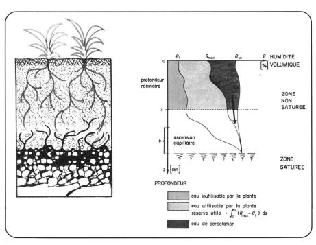
Fig. 5. Evolution d'un profil hydrique dans un sol
