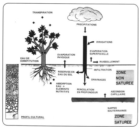
Fig. 3. Les éléments principaux du cycle hydrologique
