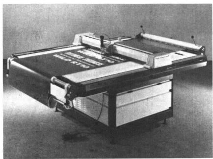
Der neue automatische Rollentransporter für Zeichnen und Schneiden auf Endlosmaterial lässt sich auch nachträglich an alle Aviatab-Präzisionsplotter von Wild Heerbrugg adaptieren.
