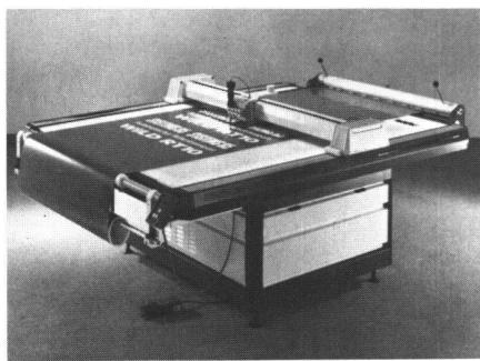
Der neue automatische Rollentransporter für Zeichnen und Schneiden auf Endlosmaterial lässt sich auch nachträglich an alle Aviotab-Präzisionsplotter von Wild Heerbrugg adaptieren.
