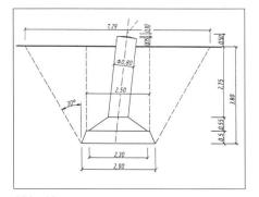
Abb. 11: Einzelfundament mit CAD gezeichnet
