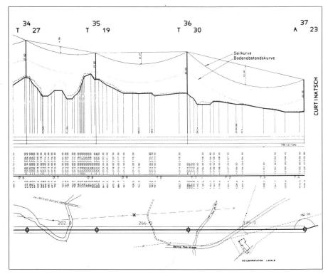
Abb. 3: Längenprofil mit Auslegung
