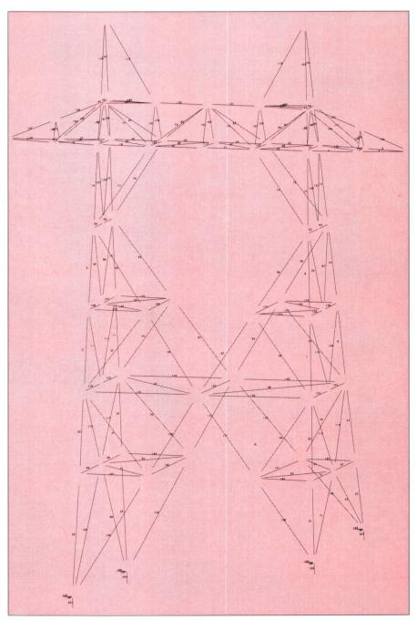
Abb. 9: Plot eines 400-kV-Mastes mit Stabnumerierung
